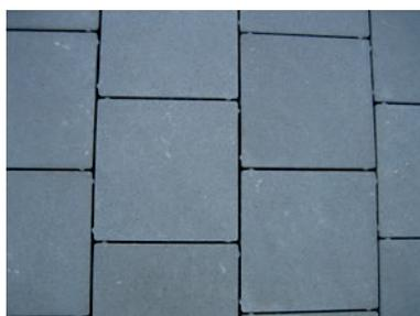
**Info:** Vollverbund auf allen Steinflanken, patentiertes Nockensystem. Systemfunktion wird durch das Aussplitten der Fugen gewährleistet. Empfohlene Körnung, Fugensplitt 1-2 / 2-4mm. Beim Steinraster 20/20 gewährleistet der Fugenanteil von 4.5% eine dauerhafte Versickerung von rund 500 l/(s·ha)
